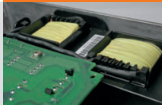
Дроссели в окне постоянного тока уменьшают гармонический шум и защищают привод.
